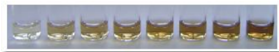
Figura 12. Seguiment de la coloració de la solució per observar l'avanç de la reacció (cada vial equival a 1ml extret del baló Schlenk de reacció cada 30min).
