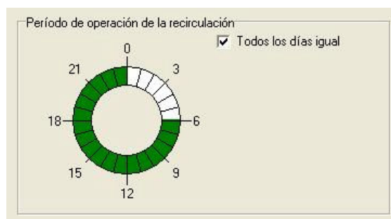
Figura 3.44 Período de operación de la bomba de recirculación en TSOL.
