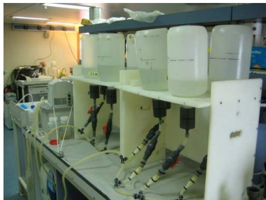
Fig. 6 Sistema de filtratge per les mostres d'aigua del Th-234. Font: elaboració pròpia.
