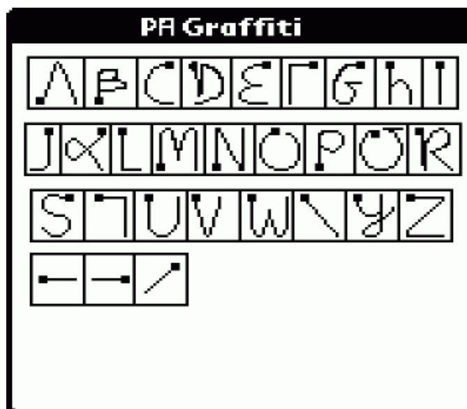
Fig. 3.7 Sistema por defecto de escritura de PALib
