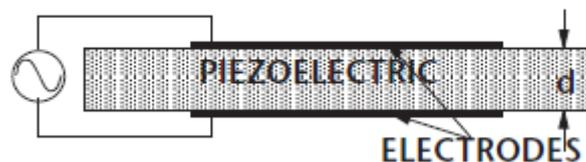
Figura 2-1. Estructura de un resonador BAW.
