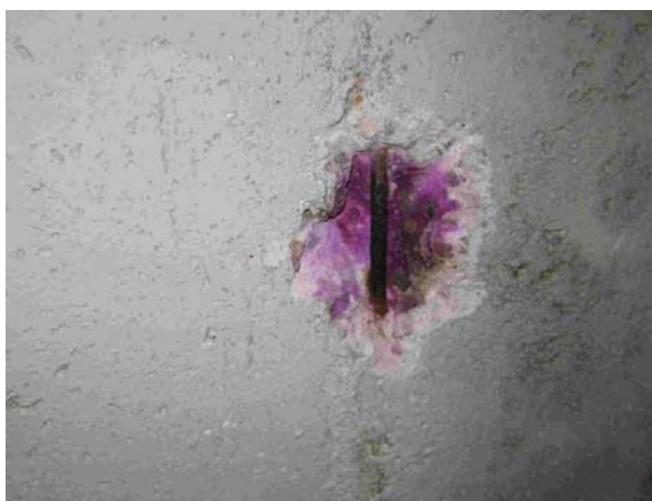
Figura 14. Carbonatación del hormigón y recubrimiento de armaduras
