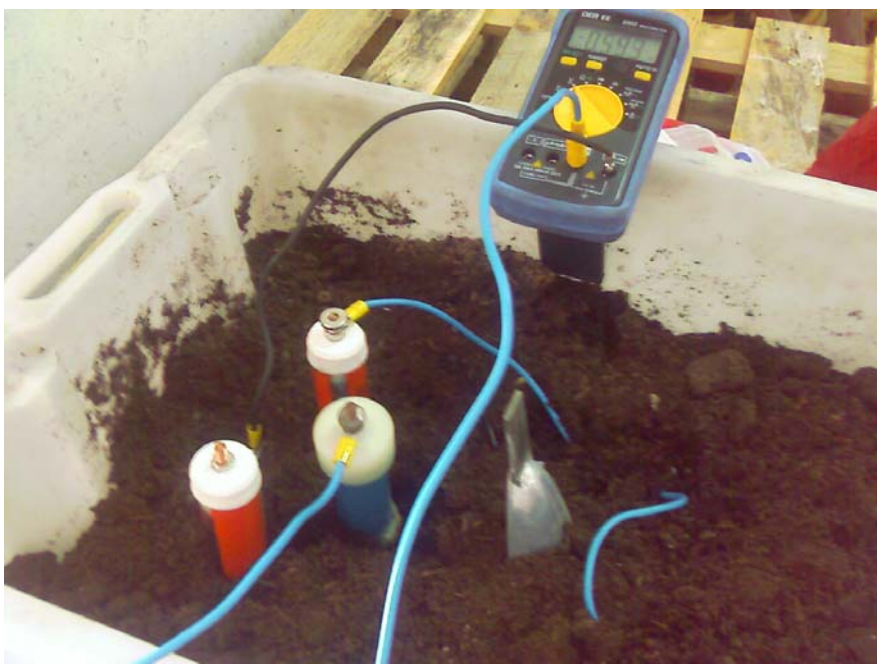
Figura 9. Medida de potencial del hierro enterrado en tierra húmeda. Comprobación del electrodo.
