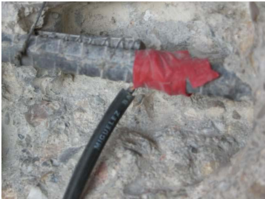
Figura 5. Conexión a la armadura para lectura de potenciales.
