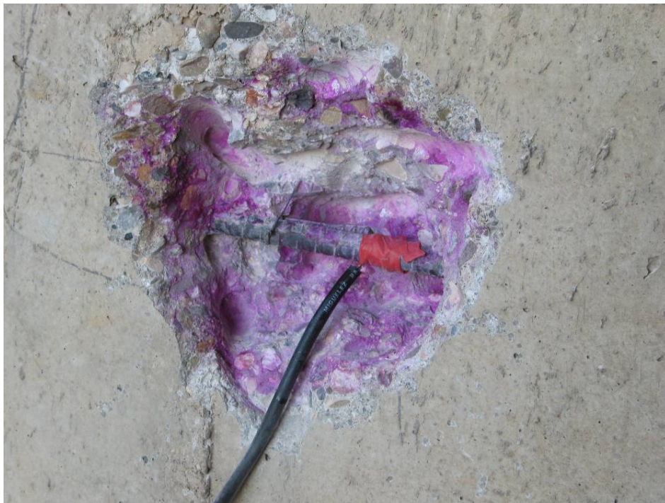
Figura 31. Recubrimiento, carbonatación y punto de conexión.
