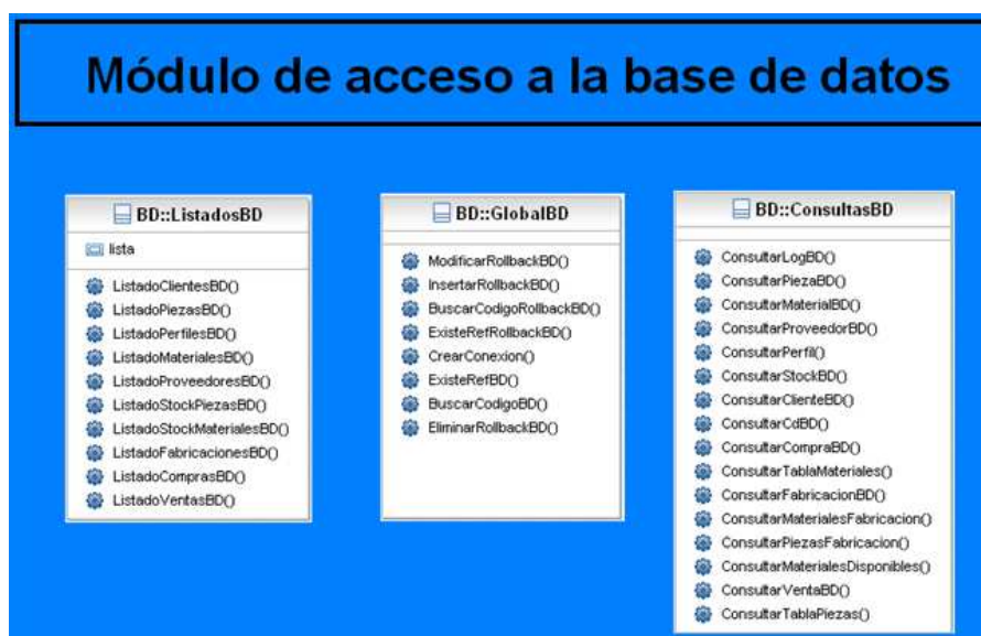
Figura 31: Diagrama de clases del módulo de acceso a la base de datos.
