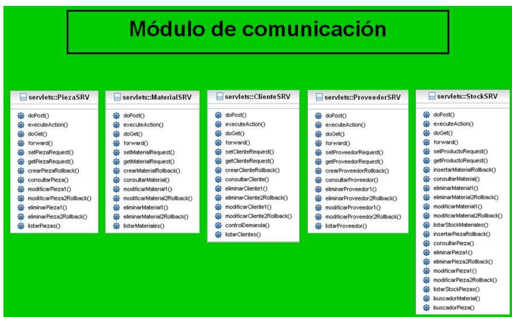
Figura 25: Primera parte del diagrama de clases del módulo de comunicación.
