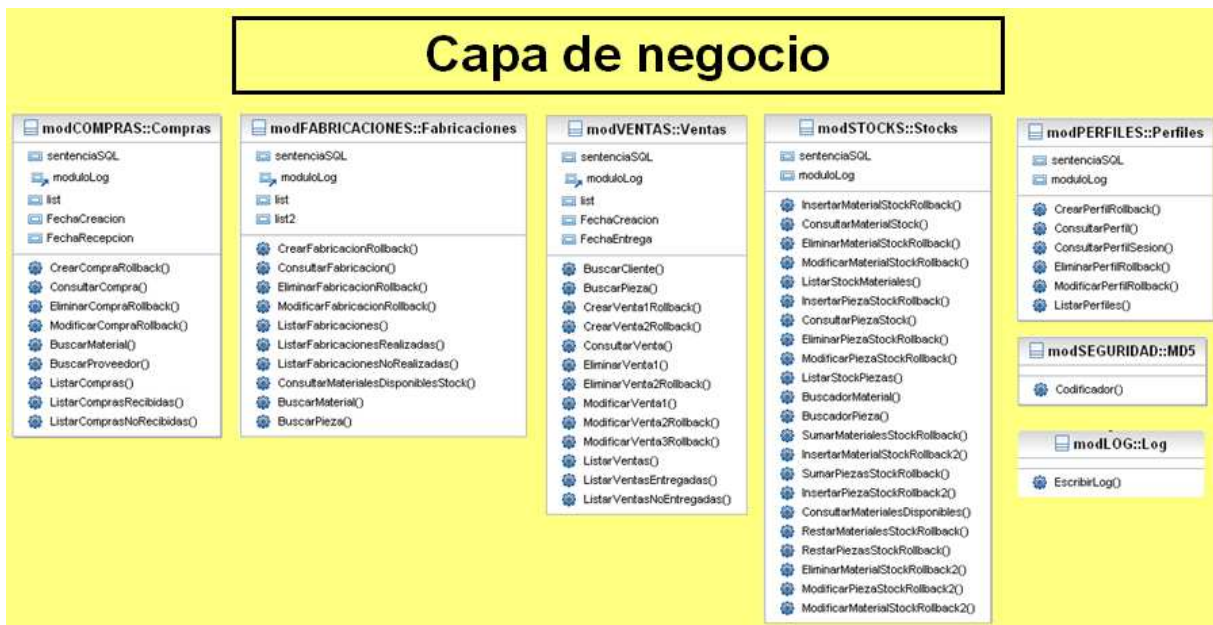
Figura 29: Segunda parte del diagrama de clases de los módulos de negocio.
