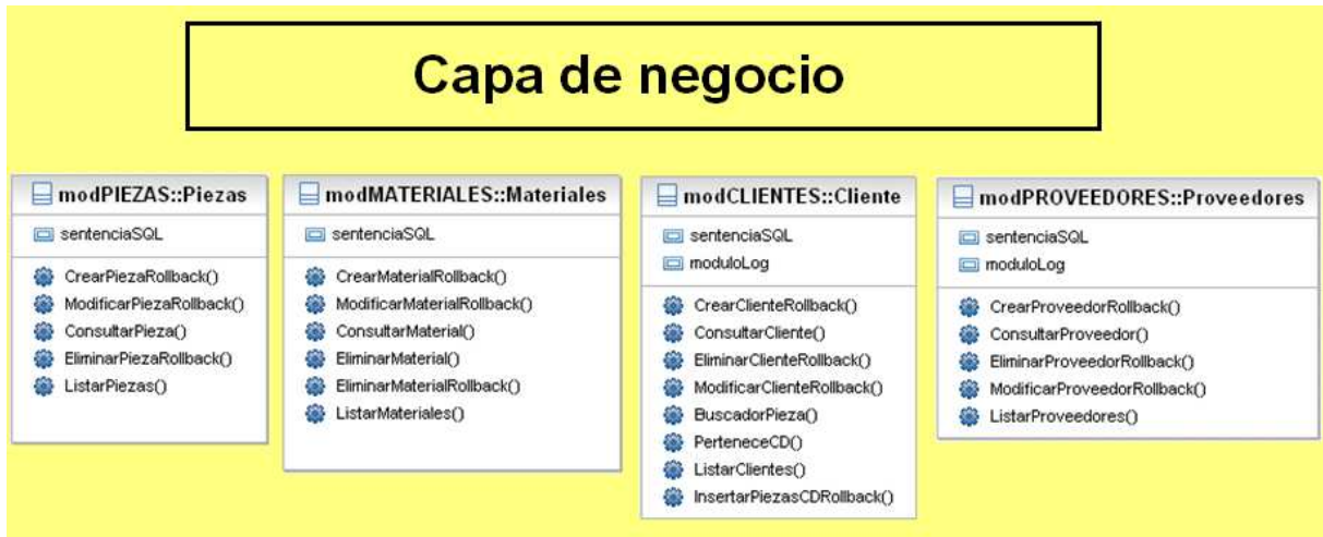
Figura 28: Primera parte del diagrama de clases de los módulos de negocio.
