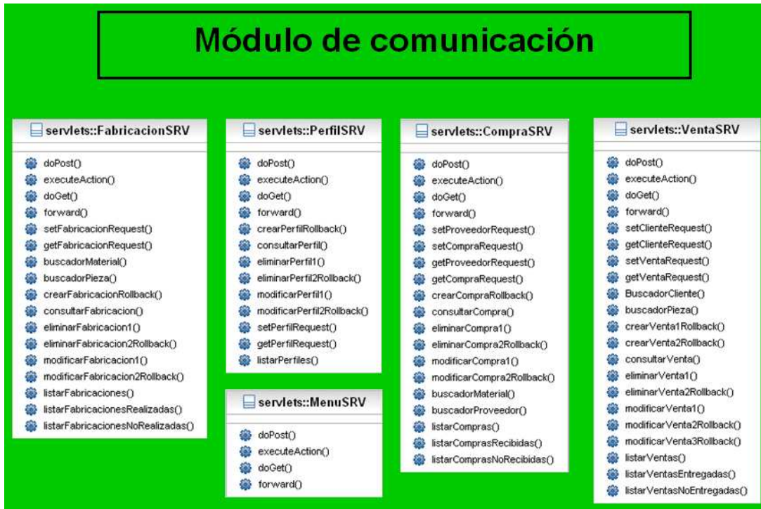
Figura 26: Segunda parte del diagrama de clases del módulo de comunicación.
