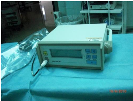
Fig. 6 Gammacámara portátil con sonda de rastreo.
