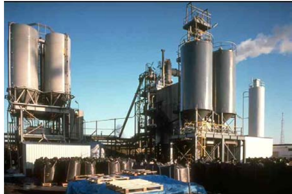
Imatge 19: Forn de regeneració de carbo granular. Font: chemvironcarbon.com
