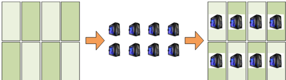
Figura 4.3: Particionamiento de bloques cuadrados en CG para 8 procesos.
