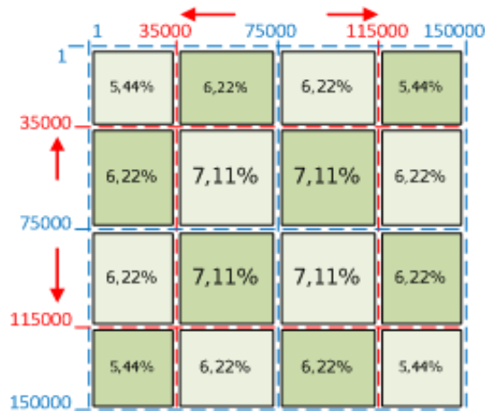
Figura 5.3: Porcentaje asignado a cada proceso del total del área de la matriz de entrada, repartición 1.
