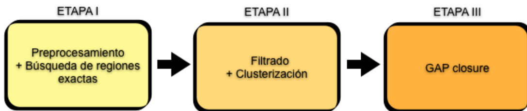
Figura 10 – Modelo de las 3 principales etapas presentes en la mayoría de algoritmos para el WGA
