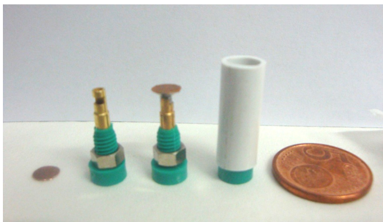
Figura 6. Fotografía de los componentes del electrodo
