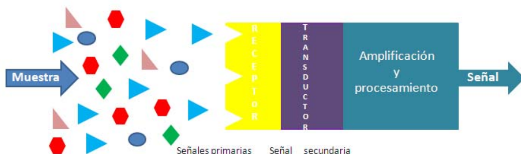
Figura 1. Esquema del funcionamiento de un sensor químico.
