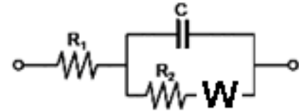
Figura 10. Circuito equivalente utilizado para obtener las medidas de impedancia.
