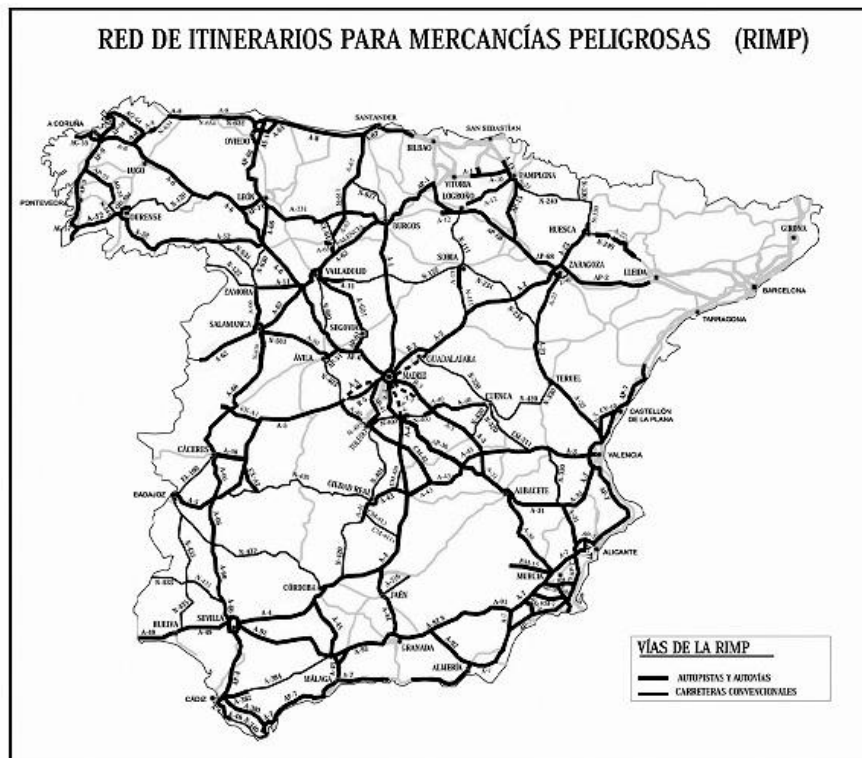
Figura 1.1.6. Red de Itinerarios para Mercancías Peligrosas de España
