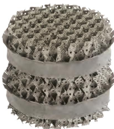
Figura 11.7.6. Empacado ordenado Mellapak de la empresa Sulzer
