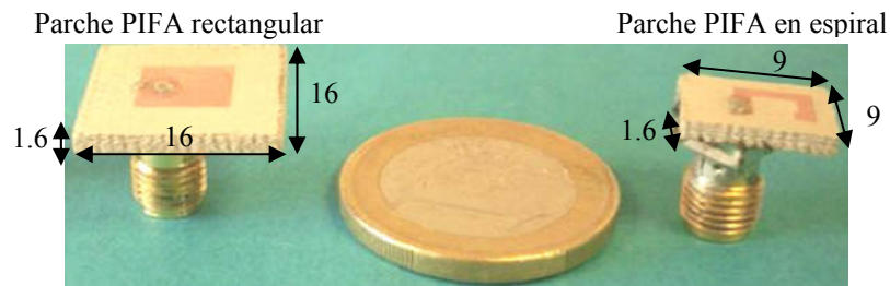
Figura 4-34 : Parches PIFA implementados con tamaños en mm
