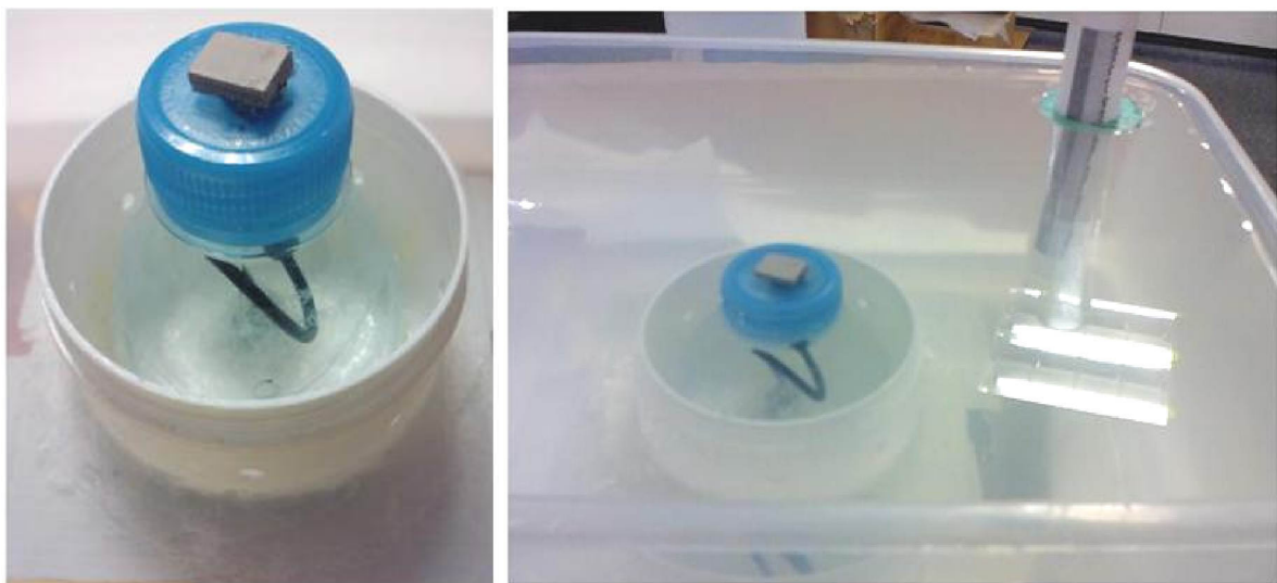
Figura 4-35 : Parche PIFA instalado en la configuración de medida top , con y sin líquido
