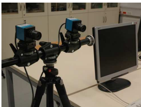
Il·lustració 3: Sistema de triangulació passiva on la posició i orientació de les càmeres son coneguts
