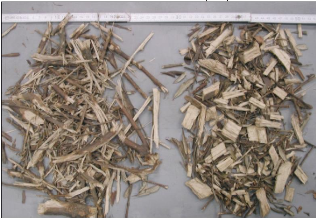
Imatge 19.1. Material produït amb una trituradora recollidora (esquerra) i material estellat amb l'estelladora Jordan (dreta)
