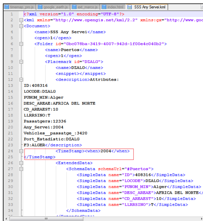
Imagen13: estructura del archivo KML con el parámetro TimeStamp, necesario para poder generar indicadores con variable temporal.
