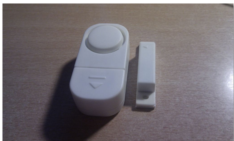
Ilustración 16: altavoz con interruptor de lengüeta
