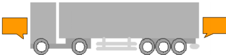
Figura 5.6.3.3 Esquema de la indicació del transport de mercaderies perilloses quan es transporten en embalums.
