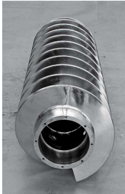
Figura 12.10.1 Cargol d'Arquímedes del decantador centrífug
