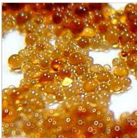
Figura 12.6.3.4 Aspecte macroscòpic típic d'una resina d'intercanvi iònic.
