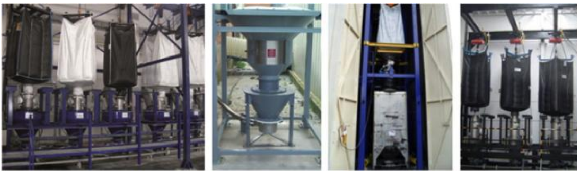
Figura 11.24.2. Sistemes de carrega i descarrega del big bag
