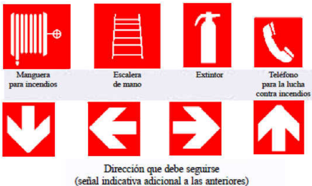
Figura 5.8.2.1-4. Algunas de las señales referidas a equipos de lucha contra incendios.
