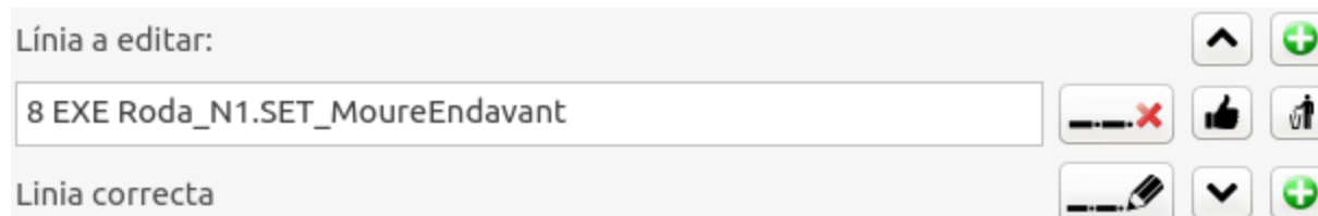
Figura 4.32: Editor de línies amb una línia completa. El botó per inserar la línia al codi està habilitat.
