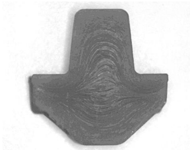
Figura 1- 12: Dirección de fibra del acero obtenida con el proceso de forja. (Delphi Diesel Systems, SL)
