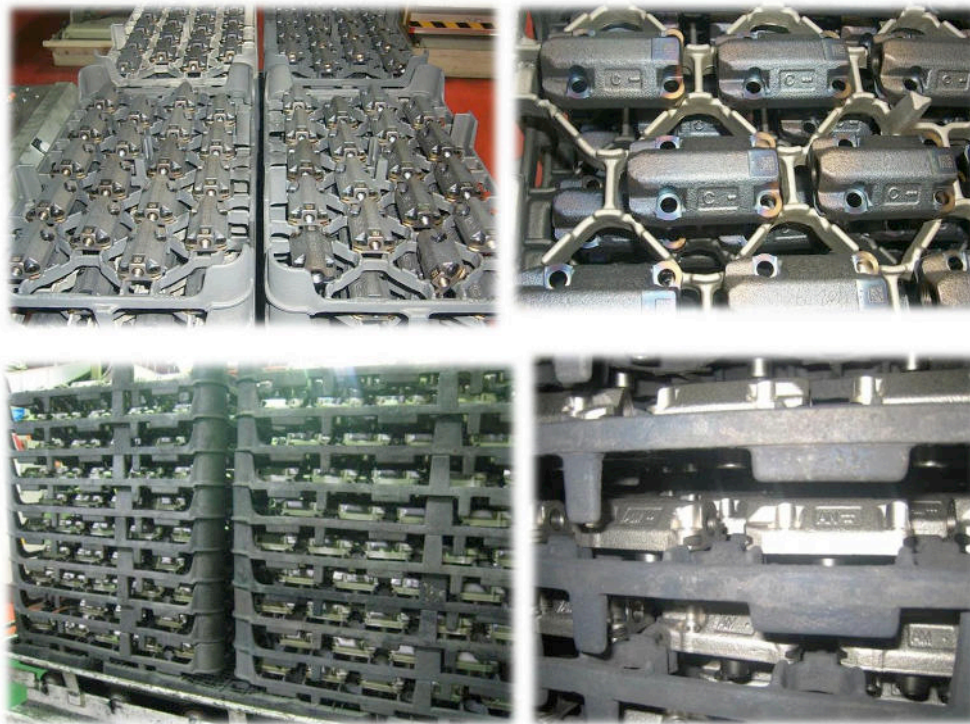
Figura 1- 17: Disposición de las piezas en la carga. (Delphi Diesel Systems, SL)
