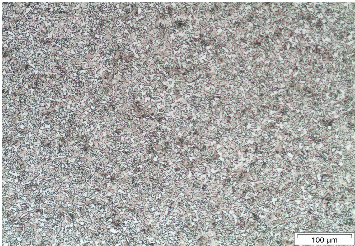
Figura 1- 35: Detalle de la microestructura en la sección del núcleo (x100). Pieza situada en los niveles inferiores.
