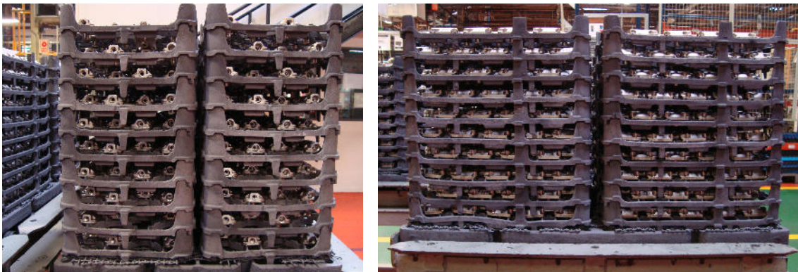
Figura 1- 24: Ejemplo de carga configurada con 10 niveles. (Delphi Diesel Systems, SL)
