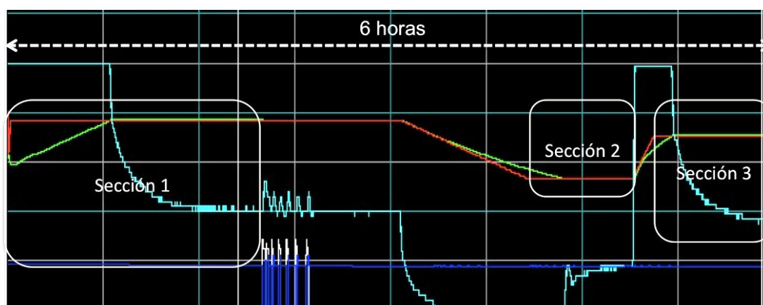
Figura 2- 1: Diagrama del proceso de cementación, identificando distintas secciones críticas del proceso. – En el eje de abscisas se representa la variable tiempo, mientras que en el de ordenadas figuran distintas variables: temperatura de consigna (rojo), temperatura real (verde), potencia de regulación de temperatura (azul), caudales de acetileno y nitrógeno (blanco y azul respectivamente).
