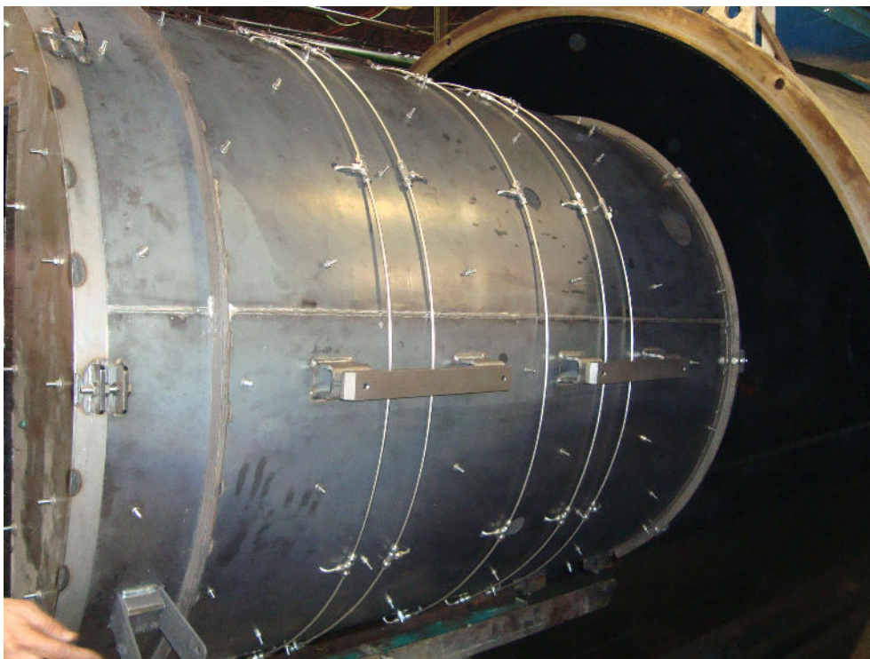
Figura A5- 7: Fotografía de un casing por su cara externa. Detalle de los anillos de inyectores. (Delphi Diesel Systems, SL)
