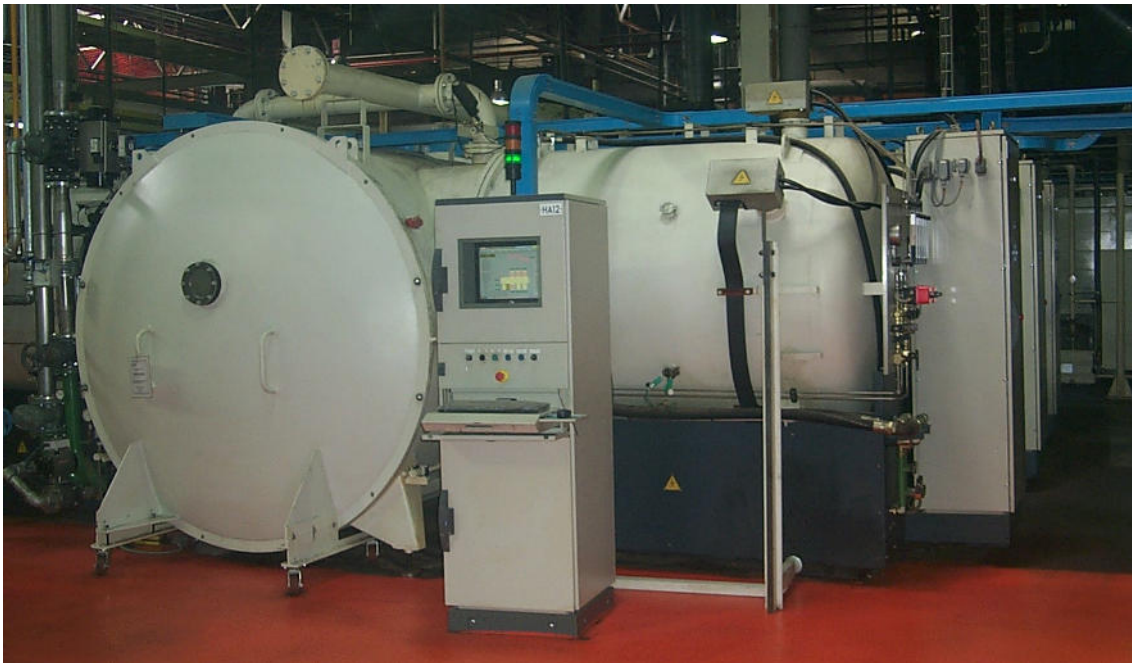
Figura A5- 4: Vista exterior de una célula de cementación, acoplada al túnel central. (Delphi Diesel Systems, SL)
