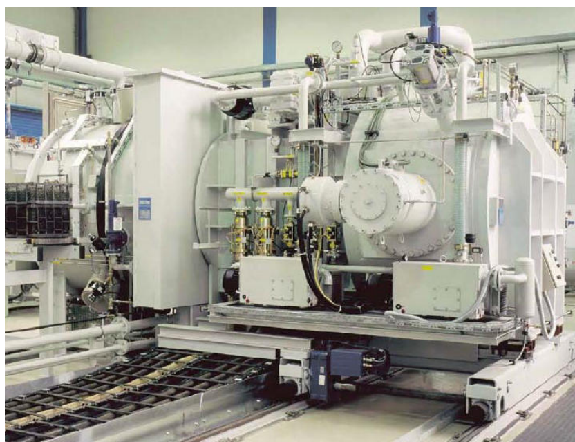
Figura A4- 17: Instalación ModulTherm, del fabricante ALD.
