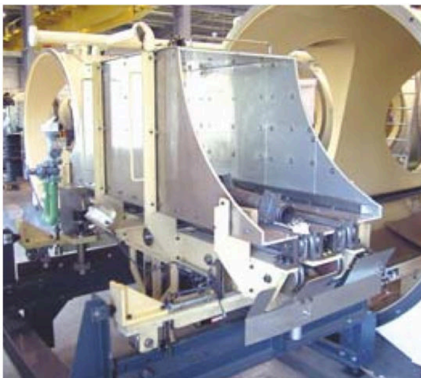
Figura A5- 10: Detalle de la cargadora interna. (ECM Fours)
