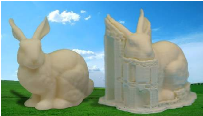
Fig. 82 Exemples de figures impreses amb material de suport i sense material de suport.
