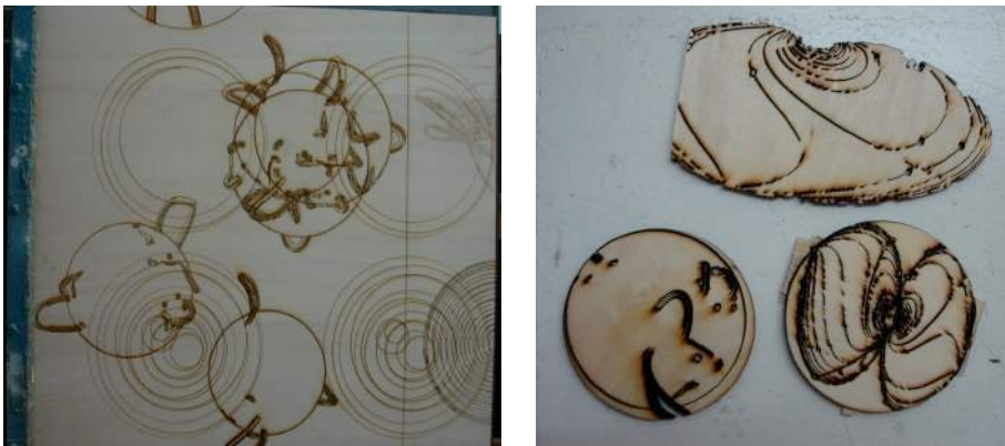
Fig 88 Esquerra: Proves de tall làser sobre paper Mylar (PET). Dreta: Dibuixos digitals utilitzats per fer aquestes proves
