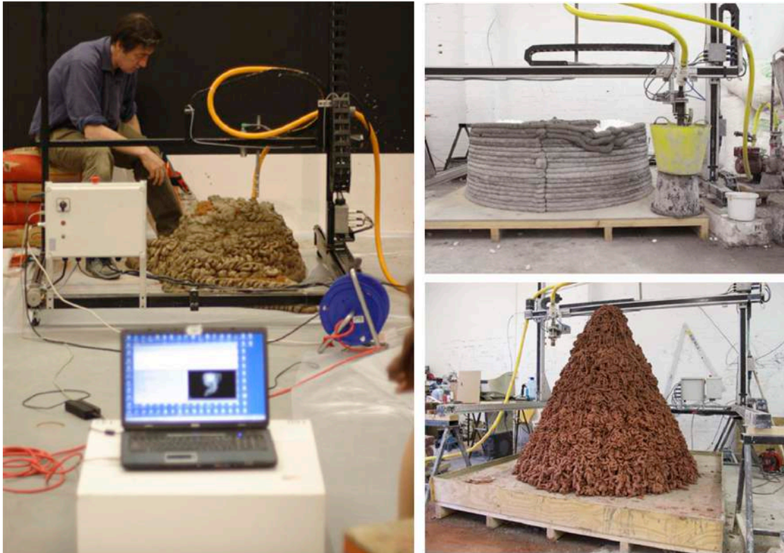
Fig. 58. Màquina feta a mida per extruir ciment i primeres proves. Autor: Anish Kapoor Títol: Greyman cries Shaman Dies Billowing Smoke Beauty Evoked Any: 2008-2009 Desenvolupament tècnic: Factum Arte (Madrid) Software: Processing Impressora: Extrusió de monofilament Material: Ciment
