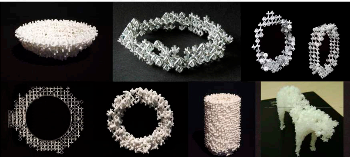
Fig 26. Exemples de figures fabricades en impressió 3d dissenyades amb el software Automake. Metall i plàstic, 2008
