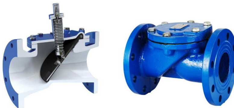
Figura 4.10.- Vàlvula de retenció tipus Rubber flapper swing
