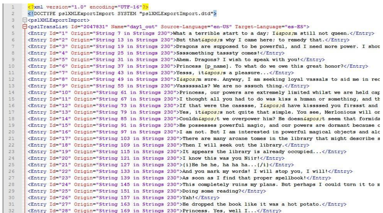
Ilustración 11: Ejemplo de la estructura de los archivos xml exportados de SDL Passolo
