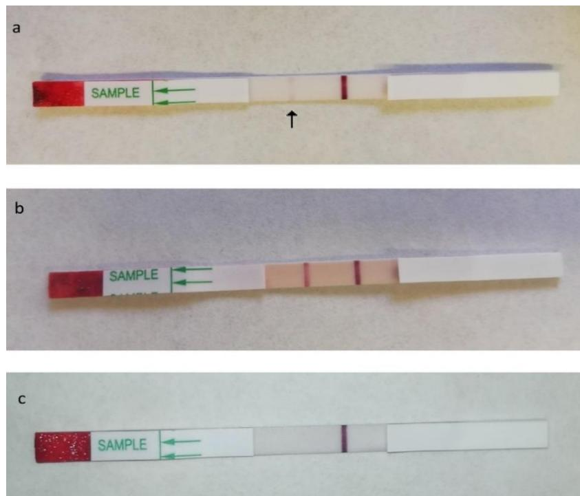
Imagen 6. PDR Trypanosoma Detect en muestras de sangre. a. Muestra positiva tenue. b. Muestra positiva clara c. Muestra negativa.
