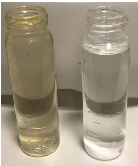
Figura 10. Muestras del efluente del reactor con relleno de madera (izquierda) y del efluente del reactor con relleno de espuma de poliuretano (derecha).
