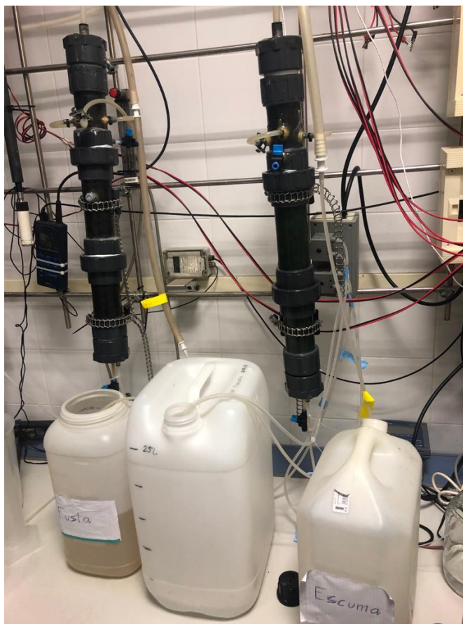
Figura 2. Montaje final del sistema de reactores desnitrificantes con relleno.
