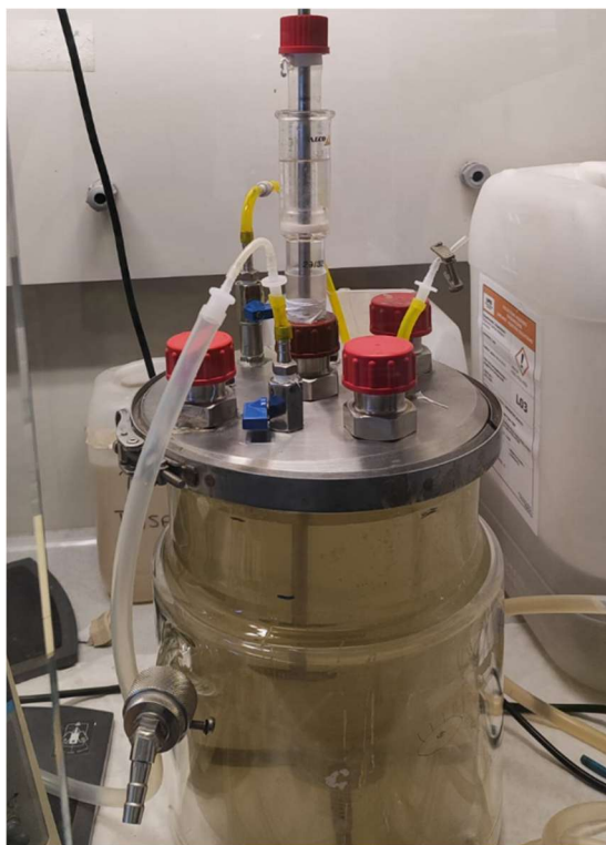
Figura 5. Imagen del biorreactor de 7,5 L empleado para la bioestimulación secuencial anaerobia-aerobia del agua subterránea del pozo 14S.
