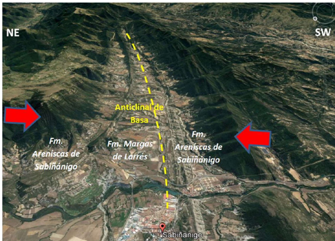
Figura A3. Anticlinal tumbado de Yebra de Basa. La línea amarilla marca el eje axial del anticlinal. Las flechas rojas indican la dirección de compresión ( \sigma_1 ).
