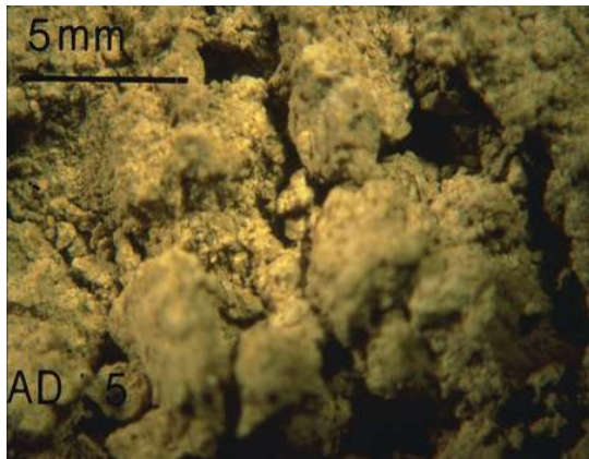
Figura 2. Micro-agrietamiento de los agregados del suelo resultado del ascenso capilar del agua.
