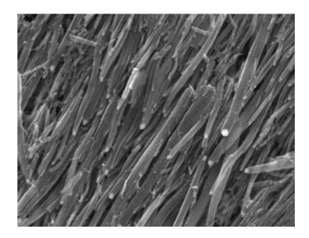
El desarrollo de nuevos biosensores de gran sensibilidad y bajo coste se está potenciando gracias a la nanotecnología. Este trabajo explora la fabricación de inmunosensores electroquímicos a partir de un compuesto de nanotubos de carbono y matriz polimérica (poliestireno), sometido a un plasma de oxígeno para mejorar el rendimiento de los sensores.
