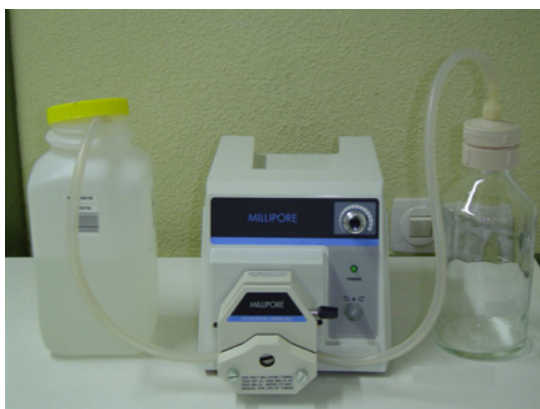
Figura 1. Equipo de filtración automática de aguas para la búsqueda de Legionella .
