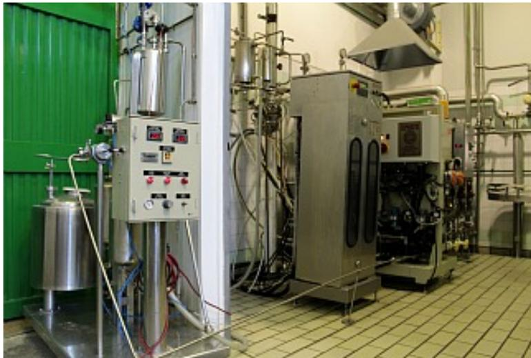
El Centre Especial de Recerca Planta de Tecnologia dels Aliments (CERPTA) de la UAB ha creado un nuevo sistema capaz de esterilizar y estabilizar líquidos mediante altas presiones que permite conservarlos largo tiempo a temperatura ambiente y reducir el uso de aditivos para conservar sus características organolépticas. La tecnología protege, además, los componentes bioactivos de los alimentos. Para comercializarla, el CERPTA y la UAB han creado YPSICON, una nueva spin-off de base tecnológica.
