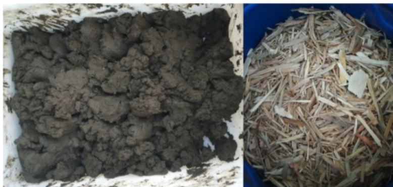
Imagen 1: Lodo fresco y palé triturado (material estructurante) antes de realizar la mezcla.
