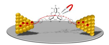
Un equipo del ICMAB-CSIC ha investigado el comportamiento de un radical orgánico como cable molecular formado a través del enlace covalente carbono-oro entre la molécula y dos electrodos. El contacto molécula-metal es más estable y geométricamente mejor definido que sus predecesores, en los que se empleaban otros grupos funcionales. Esta mejora abre las puertas a preparar nuevos dispositivos electrónicos aplicables en la Electrónica Molecular.
