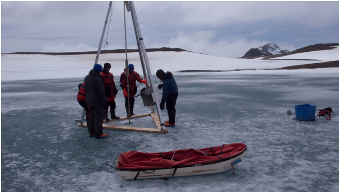
El equipo de investigación extrayendo registros para datar la erupción del volcán gracias a la plataforma de perforación sobre hielo. Fotografía de Sergi Pla Rabès.
