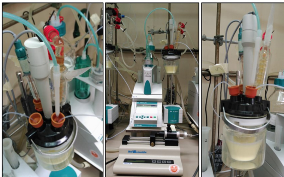
Figure 1. Bio-reactor y equipamiento utilizado en las transformaciones biocatalizadas. En la imagen izquierda, vista superior del reactor, se puede ver: el agitador, la sonda de pH, el condensador y las entradas de sustrato, NaOH (control pH) y aire. En la imagen central, vista frontal de todo el equipamiento, se puede ver: el bio-reactor encamisado (parte superior derecha de la imagen), el dosificador de sustrato (inferior de la imagen) y el controlador de pH (aparato central de la imagen). La imagen de la derecha es la vista frontal del bio-reactor con los mismos componentes descritos.
