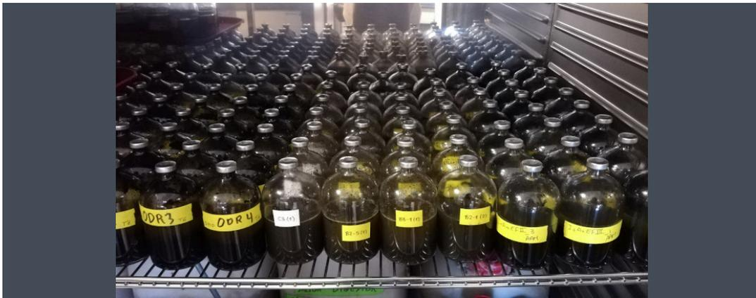
El biocarbón, conocido como *biochar*, está ganando notoriedad en la lucha contra el cambio climático. El Grupo de Investigación en Compostaje de la UAB explora su uso en la digestión anaerobia de residuos orgánicos para mejorar la producción de biogás y la estabilidad de los digestores, y contribuir así a la energía renovable y autosuficiencia energética.
