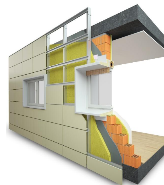
Figura 24: Estructura del aislamiento térmico en fachada exterior
